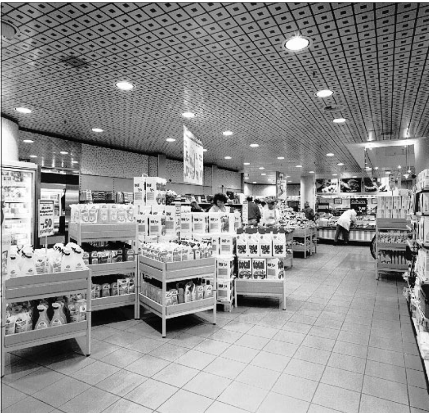
Figura 2.8: illuminazione generale con downlight (fonte: Regent)
